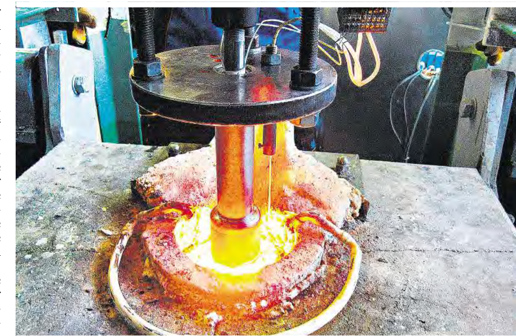
Beim „SSCT-Test“ wird eine aus der Schmelze erstarrte Stahlschale unter Zugspannung verformt
