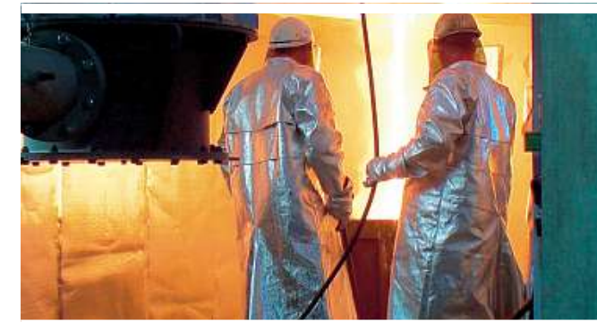
Abstich der Schlacke nach einem Einschmelzversuch von LD-Staub
