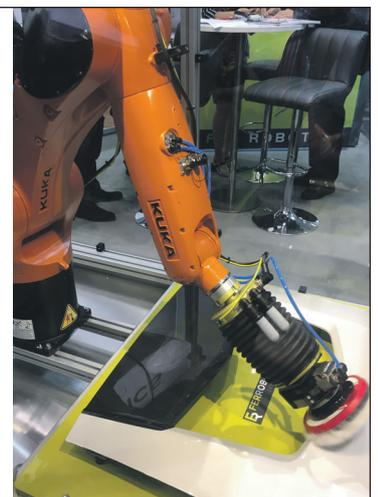
Ein Schleif- und Polierroboter von Ferrobotics. Foto: Preining
