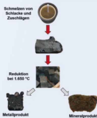
Abb. 15: Schematische Darstellung des InduRed-Verfahrens
