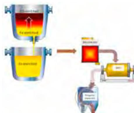
Abb. 17: Schritte der Konverterschlackenbehandlung im Projekt SLAGREUS (Quelle: Projektantrag SLAGREUS).
