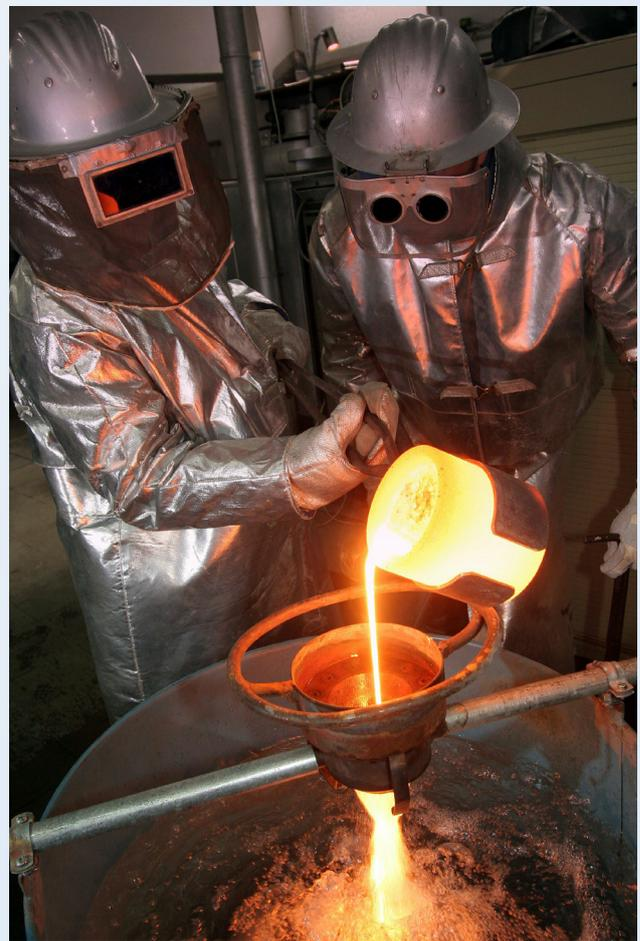
Abb.12: Abkühlung und Granulation von reduzierter Stahlwerksschlacke (Quelle: FEHS Institut für Baustoffforschung e.V.).
