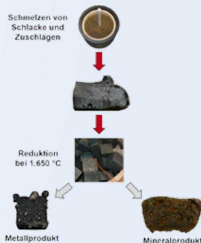
Abb. 15: Schematische Darstellung des InduRed-Verfahrens
