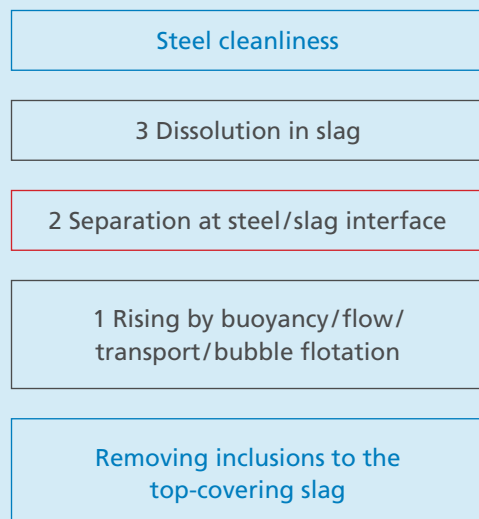
Abb. 18: Schematische Darstellung der Entfernung nichtmetallischer Einschlüsse durch Schlackenabsorption in einem industriellen Tundish. Quelle: JKU Linz/K1-MET
