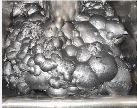
Abbildung 1: Aufschwimmender Graphitschaum bei der Schaumflotation von Schwarzmasse. (© UVR-FIA GmbH).
