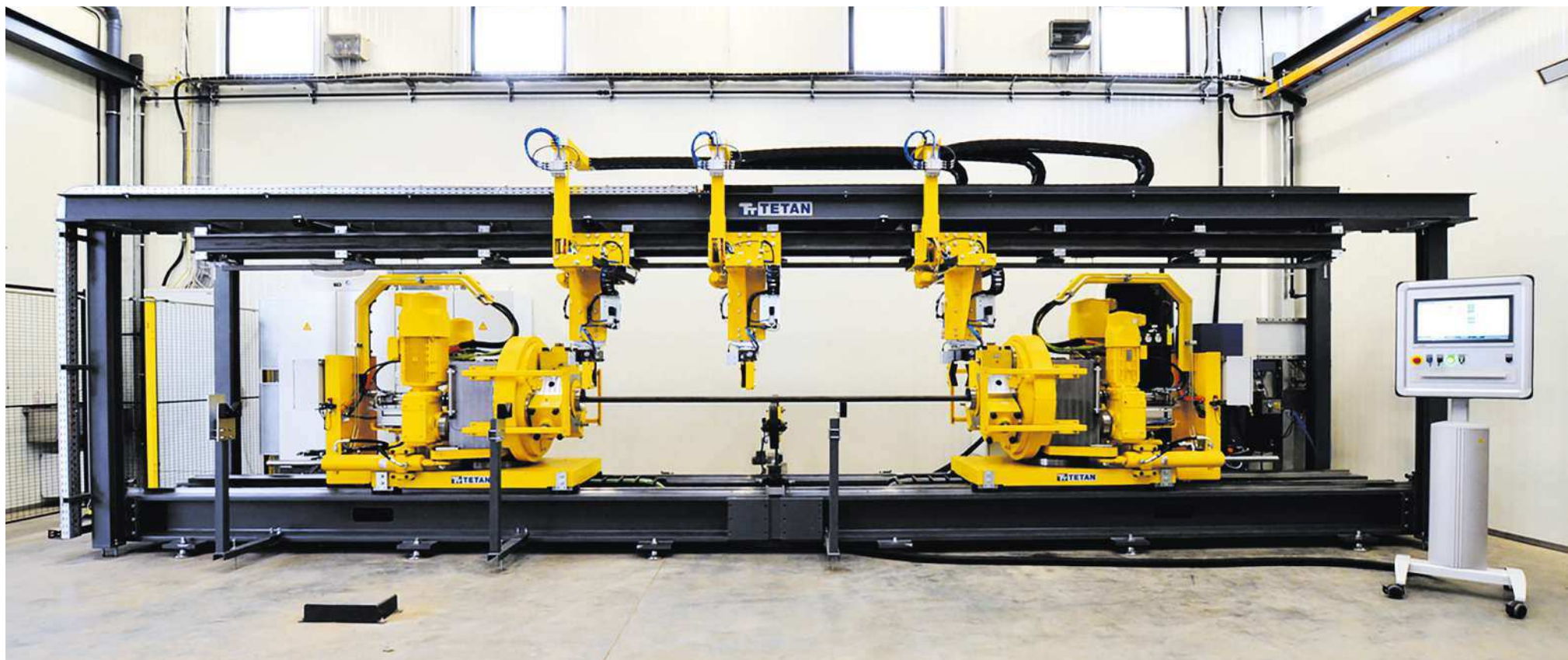
Rohre und Stangen können mit der neu entwickelten Technologie „S F F S“ in der TETAN-Richtmaschine (fast) berührungslos geradegerichtet werden
