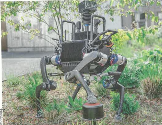
Erinnert stark an einen Hund: Der Laufroboter Anymal, der von Wissenschaftlern der ETH Zürich entwickelt wurde, soll mit seinen vier Beinen auch unwegsames Gelände autonom überwinden können.
