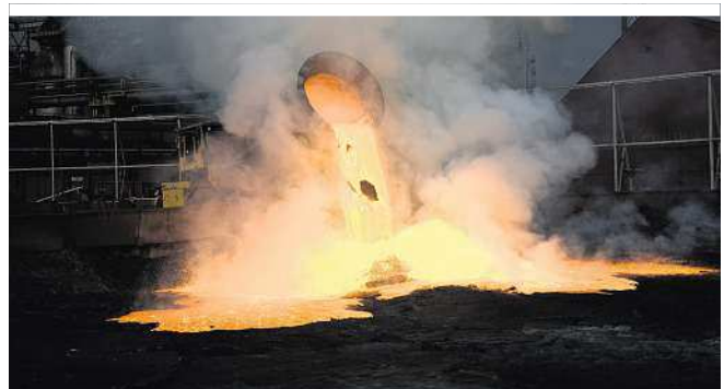
Auskippen von Stahlwerksschlacke für die Wiederverwertung
