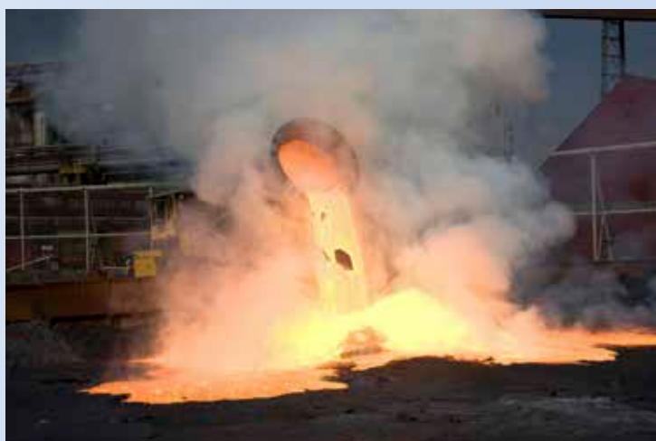
Abb. 9: LD-Schlacke (voestalpine Stahl GmbH)
