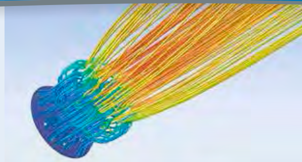
Abb. 14: Simulation der Strömung aus dem Brenner eines Industrieofens (Montanuniversität Leoben)
