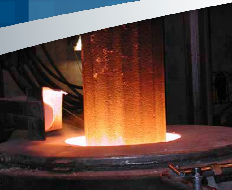
Abb. 11: Elektroschlacke-Umschmelzverfahren zur Stahlveredelung (Böhler Edelstahl GmbH & CO KG)
