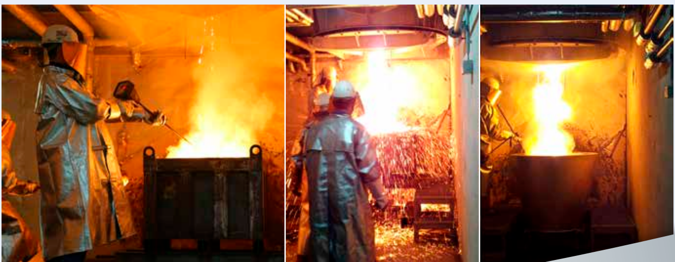
Abb. 6: Abstich an der Flash-Reaktor Pilotanlage (Montanuniversität Leoben)
