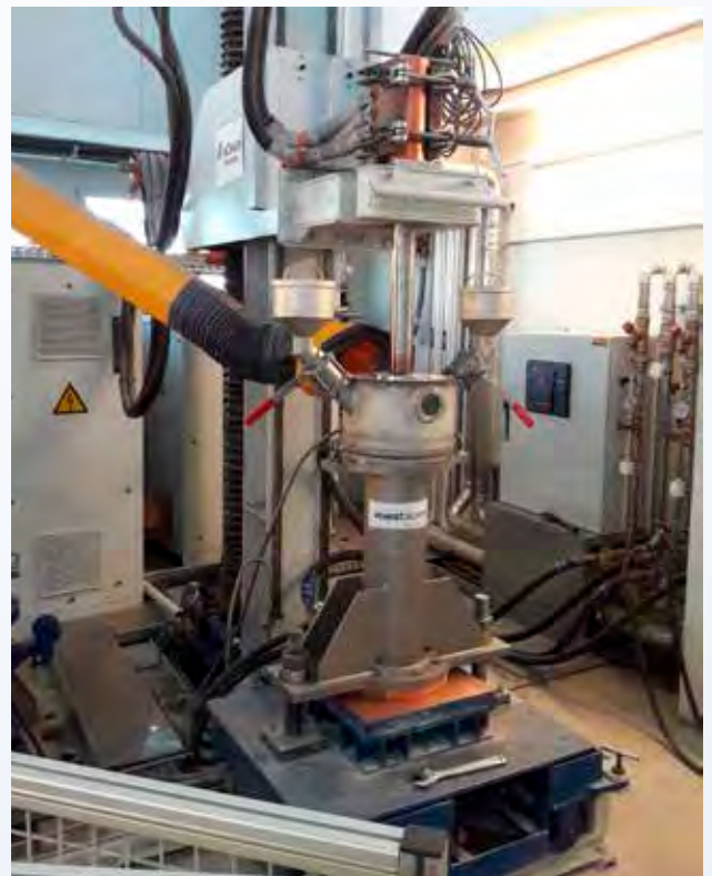
Abb. 19: Versuchs-ESU-Anlage an der FH OÖ in Wels mit neuer Kokille im Schutzgasbetrieb
